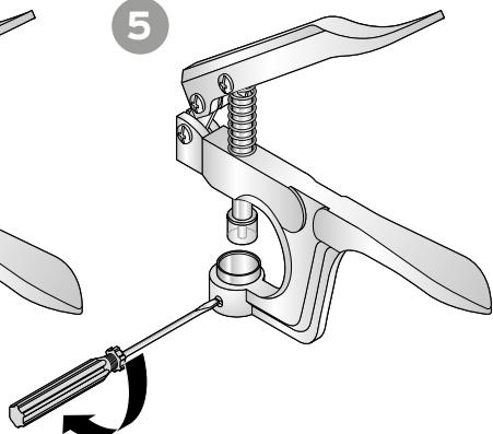
Bolzen wechseln • Change bolt • Changer de socle • Výměna čepu
